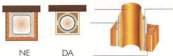
Preporučuje se da dimnjaci budu kružnog preseka, od keramičkog materijala, obloženi izolacijom od kamene vune, spolja obloženi betonskim plaštom i dimovodna cev mora biti odgovarajućeg preseka
