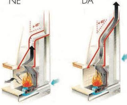
Dimnjača (uključna cev u dimnjak) mora biti uključena na dimnjak pod uglom od minimalno 45 stepeni
