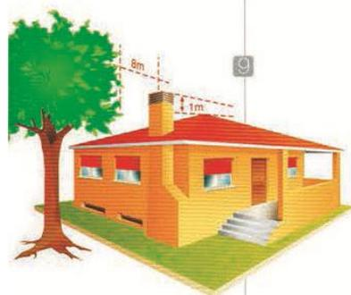
Pri formiranju dimnjaka moramo voditi računa da nam visina dimnjaka bude višlja za min. 1m od slemena krova i dimnjak udaljen najmanje 8m od dominantne krošnje drveta koje se nalazi u blizini kuće
