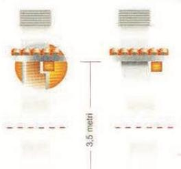
U dimnovodnoj cevi ne sme biti prepreka koje sužavaju dimnovodnu cev (naročito zapaljive) sve takve prepreke treba izmestiti van dimnjaka.
