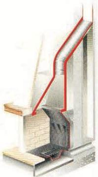
Izrada kamina mora biti od vatrostalnih, antikorozivnih materijala, a vazdušne komore izolovane i kaširane sa adekvatnom aluminijumskom folijom
